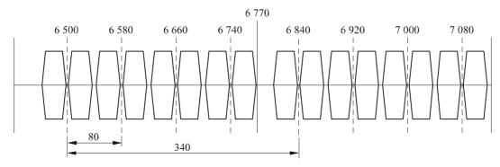
a) Disposición de canales preferida si es necesario mantener la compatibilidad con los sistemas de radioenlaces analógicos
