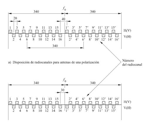
b) Disposición de radiocanales para antenas de dos polarizaciones
