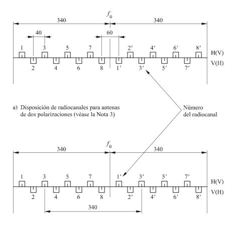
b) Disposición de radiocanales para antenas de una polarización o una antena común de transmisión/recepción con doble polarización (véase la Nota 3)
