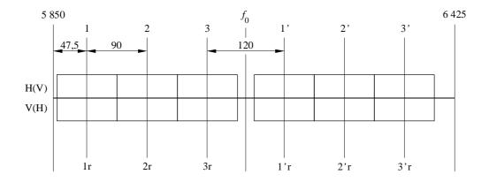
$f_0$  (fréquence centrale) = 6 137,5 MHz Rapidité de modulation = 74 MBd X = 1,22 Y = 1,62 Z = 0,64
