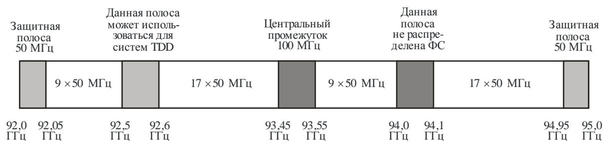
*Примечание 1.* – На рисунке 2 изображен занимаемый спектр в полосе 92,0–95,0 ГГц, предназначенный для систем, использующих FDD. Радиостволы с номерами  $n = 5'$  и  $6'$  плана размещения 100 МГц и с номерами  $n = 10'$  и  $11'$  плана размещения 50 МГц не должны использоваться. Непарные полосы частот 92,45–92,65 ГГц плана размещения 100 МГц и 92,5–92,6 ГГц плана размещения 50 МГц могут использоваться для систем TDD.
