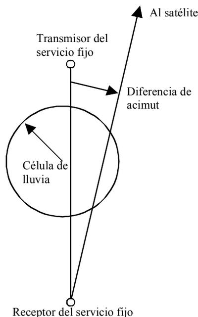
Cuando la atenuación de los trayectos deseado e interferente sólo está parcialmente correlada, es posible describir la interferencia como dos componentes, una constante y una perfectamente correlada. Suponiendo que la fracción  $p$  de la potencia de interferencia sin desvanecer está correlada y  $1 - p$  es constante, en el umbral y utilizando los elementos del Apéndice 2:
