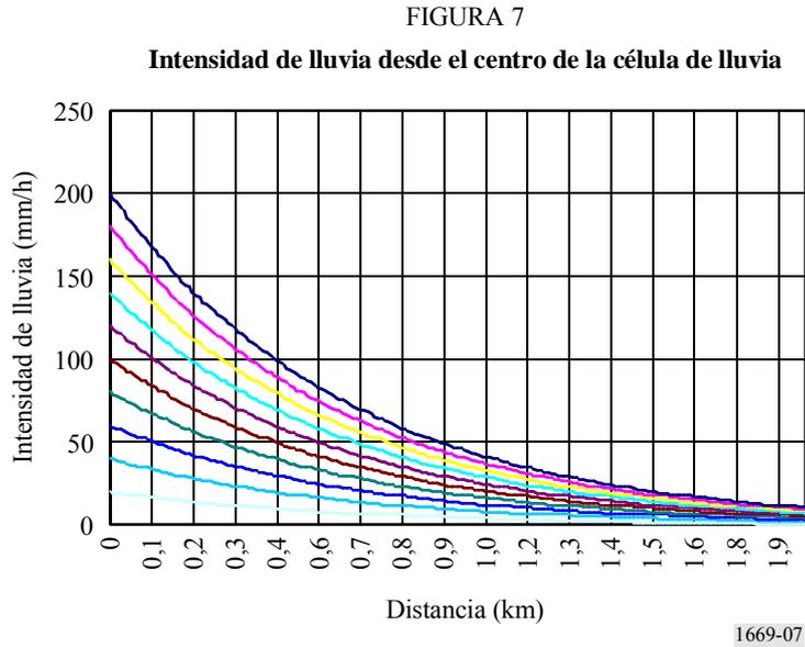
Además, basándose en la Recomendación UIT-R P.838, es posible obtener las correspondientes atenuaciones específicas representadas en la Fig. 8, utilizando las intensidades de lluvia de la Fig. 7.
