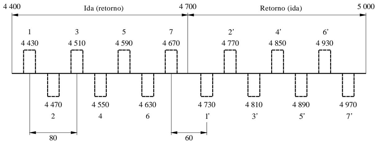
Nota 1 – Cuando inicialmente están planificados o se precisan menos canales (cuatro o menos) de radiofrecuencia, las asignaciones por pares de Ida y Retorno podrán emplear la misma polarización. En ese caso, sólo se utilizan los canales pares o impares.
