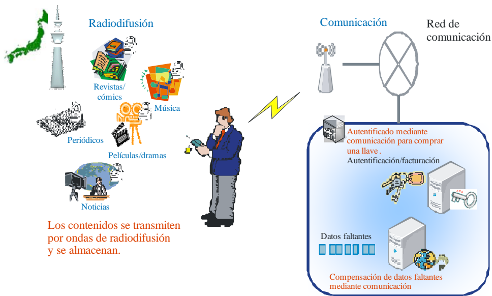
Panorama general de un sistema de radiodifusión por ficheros que utiliza canales de radiodifusión y redes de telecomunicaciones
