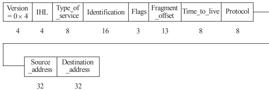
FIGURA 4 Estructura de IPv4_header_wo_length ( )
