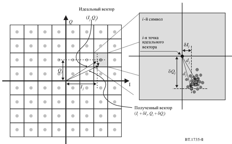
Определение MER не предполагает использования эквалайзера, однако в измерительный приемник может быть встроен эквалайзер коммерческого качества, позволяющий получить более представительные результаты в тех случаях, когда сигнал в точке измерения имеет линейные искажения.
