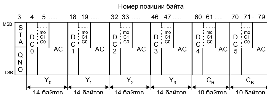
Структура сжатого макроблока в формате сжатия 4:1:1
