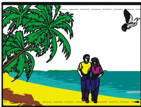
Пример 1. – Формат изображения 4:3, полученный из источника 16:9, показывающий по вертикали остаточную часть после кадрирования формата 14:9 часть кадра, а также сюжетно важную часть изображения.
