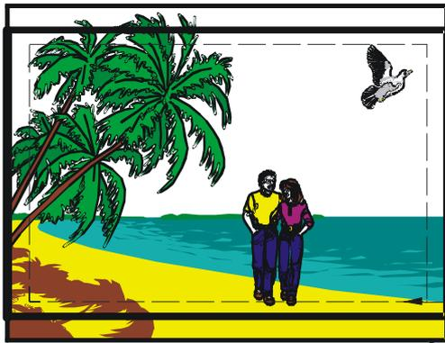
Изображение формате 4:3, наблюдаемое в камере и на стандартном устройстве отображения, показывающее предлагаемую прямоугольную рамку на экране видеоскатора камеры для кадрирования формата 14:9, а также сюжетно важной части изображения формата 14:9 (90% от ширины/высоты зоны кадрирования формата 14:9).
