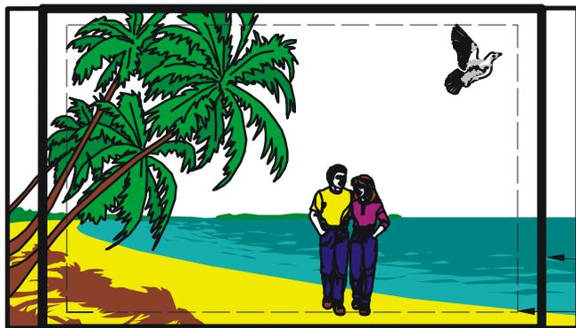
Изображение в формате 16:9, наблюдаемое в камере и на широкоэкранном устройстве отображения, показывающее предлагаемую прямоугольную рамку на экране видеискателя камеры для кадрирования формата 14:9 (90% от ширины/высоты зоны кадрирования формата 14:9).
