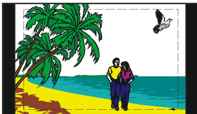
Exemple 4 - Format 16:9 obtenu à partir d'une source 4:3, montrant la zone résiduelle du cadrage 14:9 et la zone utile résiduelle de ce format. Petites bandes noires latérales.
