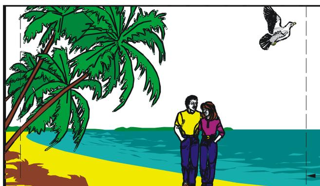
Exemple 3 - Format d'image 16:9 obtenu à partir de la source 4:3, montrant la zone résiduelle du cadrage 14:9 et la zone utile résiduelle correspondant à ce format. La largeur initiale de l'image est maintenue, le recadrage au format approximatif 14:9 se faisant en hauteur. Pas de bandes noires.
