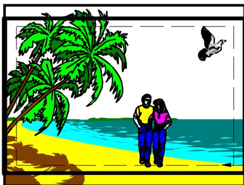
Image 4:3 observée dans le viseur de la caméra ou sur un écran conventionnel, montrant le réticule proposé pour le format 14:9 et la zone utile de l'image 14:9 (90% de la zone de cadrage 14:9).
