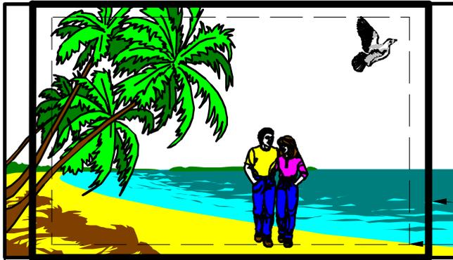
Image 16:9 observée dans le viseur de la caméra ou sur l'écran d'affichage large, montrant le réticule proposé pour le format 14:9 et la zone utile 14:9 correspondante (90% de la zone de cadrage 14:9).
