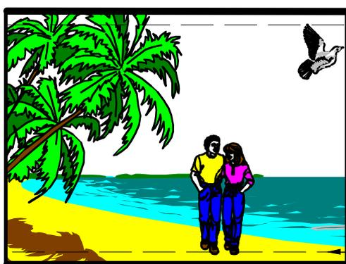
Ejemplo 1 - Formato de imagen de 4:3 extraído de fuente de 16:9 mostrando el encuadre y la zona de acción de 14:9 vertical residual. Se mantiene la altura original de la imagen pero se recorta la anchura aproximadamente al límite de acción de 14:9. Sin barras negras.
