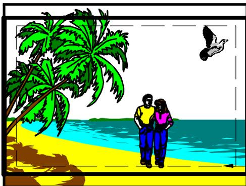
Imagen de 4:3 según se ve en la cámara y en presentación visual normalizada mostrando las retículas de pantalla de visor de la cámara propuestas para el encuadre de 14:9 y zona de acción de 14:9 (90% de la anchura/altura de la zona de encuadre de 14:9).
