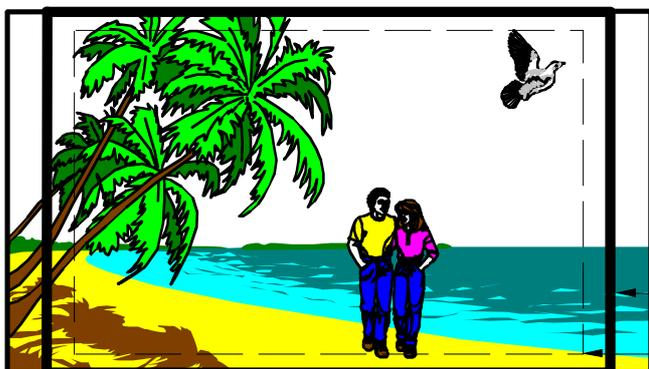
Imagen de 16:9 según se ve en la cámara y en presentación visual de pantalla grande mostrando las retículas de pantalla de visor de la cámara propuestas para el encuadre de 14:9 y zona de acción de 14:9 (90% de la anchura/altura de la zona de encuadre de 14:9).
