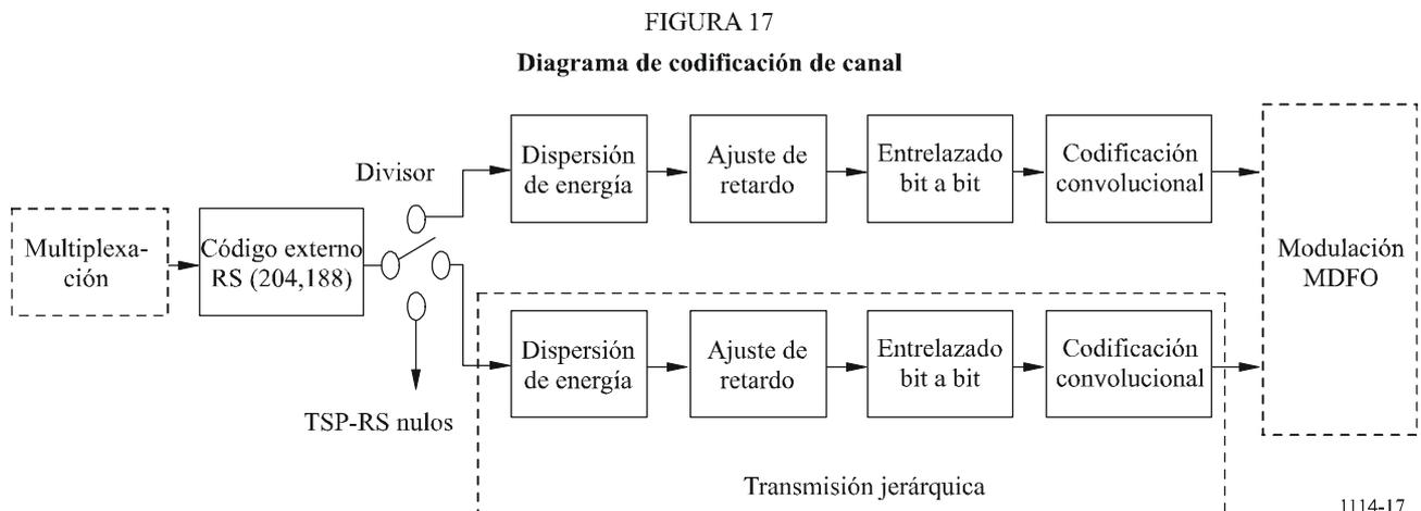
La duración de la trama múltiplex coincide con la trama MDFO mediante la cuenta de los bytes en la trama múltiplex utilizando un reloj más rápido que el reloj de muestreo IFFT que se describe en el punto anterior.
