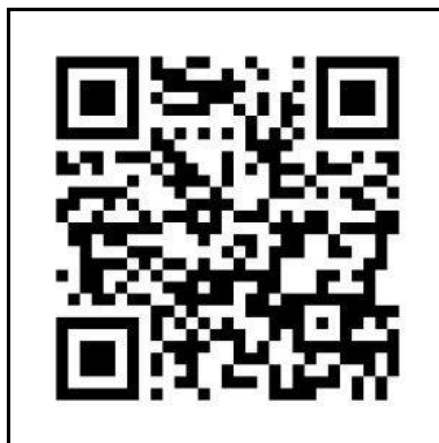
Рисунок 8 – Примеры матричных (двумерных) штрих-кодов
