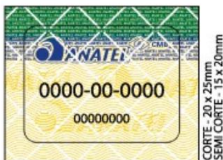
Рисунок 1 – Пример защищенной метки, требуемой Anatel и определенной в ее резолюции 481/2007
