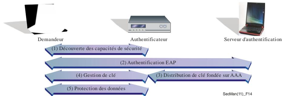
Figure 14 – Phases pour l'authentification et la gestion de clé pour la couche inférieure
