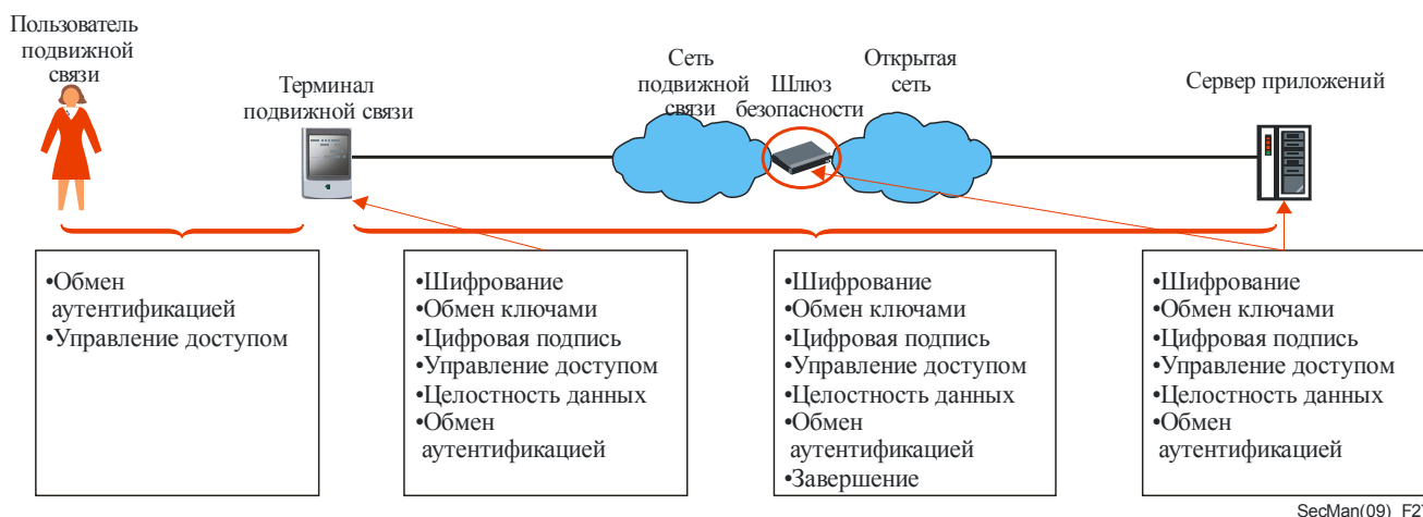
Рисунок 26 – Угрозы в подвижной связи между оконечными пунктами
