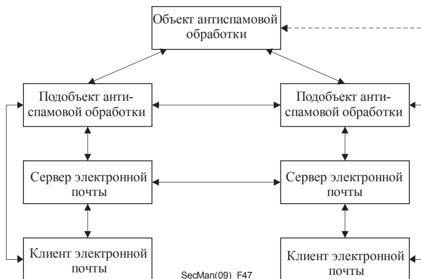
Рисунок 47 – Общая структура домена обработки для борьбы со спамом
