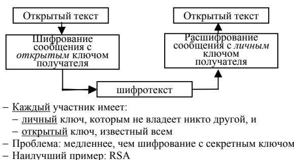
Рисунок 11 – Иллюстрация процессов шифрования с секретным и с открытым ключом
