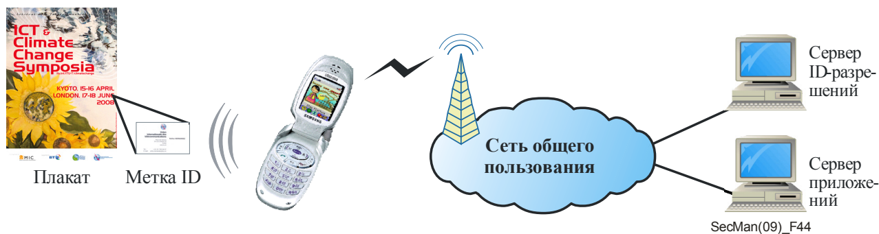
Рисунок 44 – Основная модель применения B2C при помощи идентификации на основе меток
