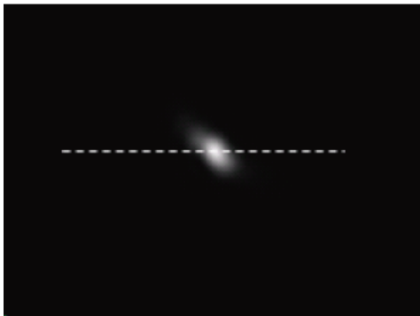
مخطط إشعاع ليزر شلالي كمي لمحساس صفييف تيراهيرتزي مع عدد الليكسيالات يبلغ 240 X 320، وبعد فاصل بينها قدره 23,5 \mu\text{m}
