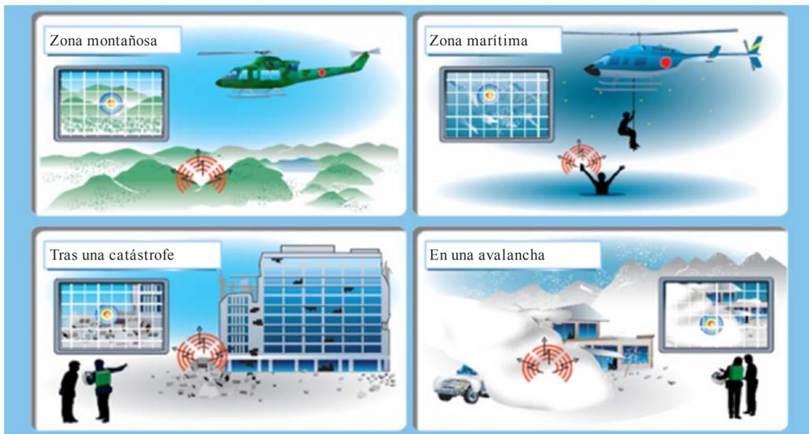
Detección de las ondas radioeléctricas de teléfono móvil que envía una llamada de socorro
