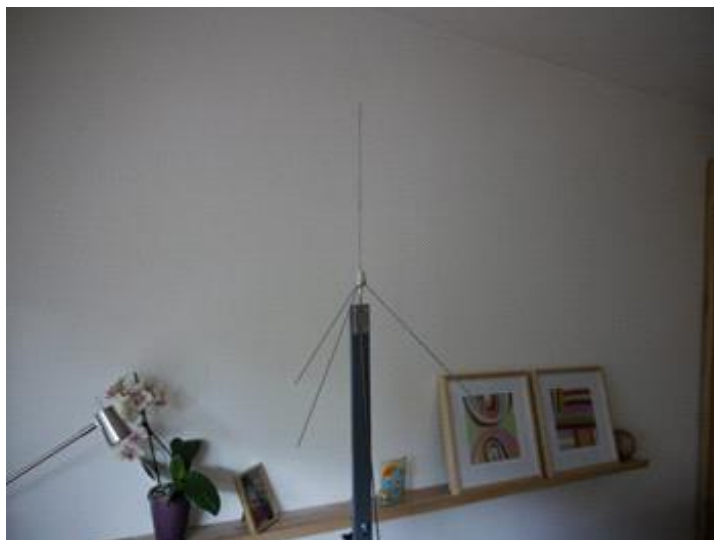
FIGURA 4 Medición por antenas de plano de Tierra con polarización vertical
