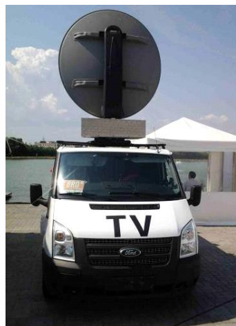
FIGURA A7.19 Estación de comunicaciones Tierra-satélite en el Centro de Deportes AkBure
