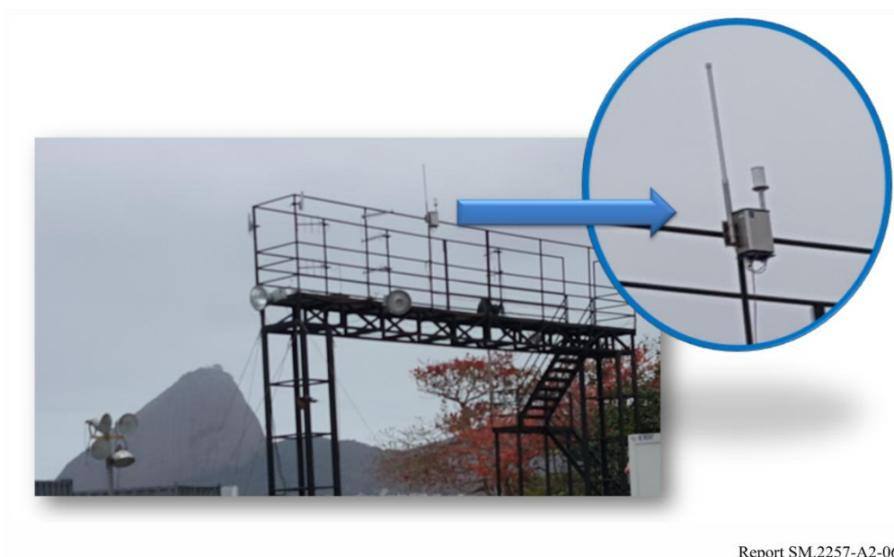
Sensor RF de Anatel en Marina da Gloria (competiciones olímpicas de vela)
