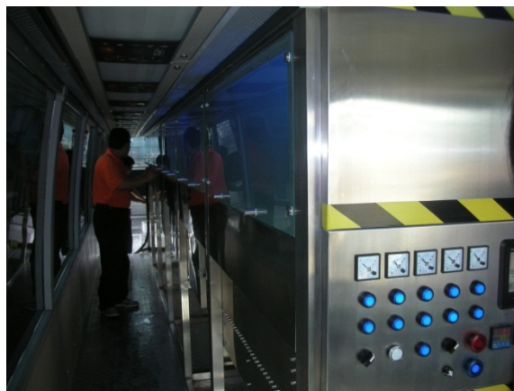
“双信道微波炉”的内部
