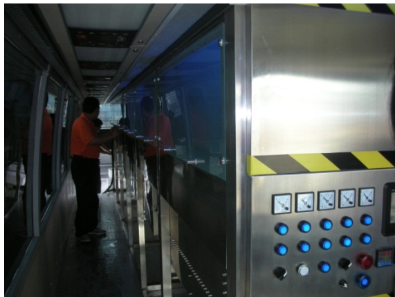
Внутренний вид двухканальной микроволновой печи
