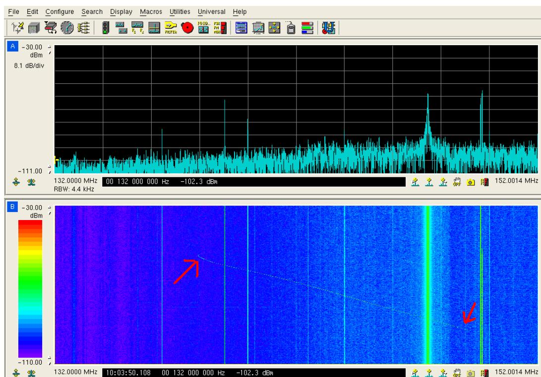
如图1.5所示，传统频谱分析仪无法找出扫描、频率调制信号（图上半部分），而实时分析仪则以瀑布模式记录其踪迹（图的下半部分）。
