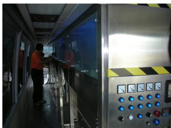
中国的2 400-2 500 MHz频段分配用于“工业、科学和医疗（ISM）应用，在这些频段工作的无线电通信业务必须接受可能由这些应用造成的有害干扰。”然而，考虑到WLAN对奥运会的重要性，因此应对其予以保护。有鉴于此，相关方面找到了折中办法，在微波炉外围安装了屏蔽设施，从而使WLAN业务质量大为改善。
