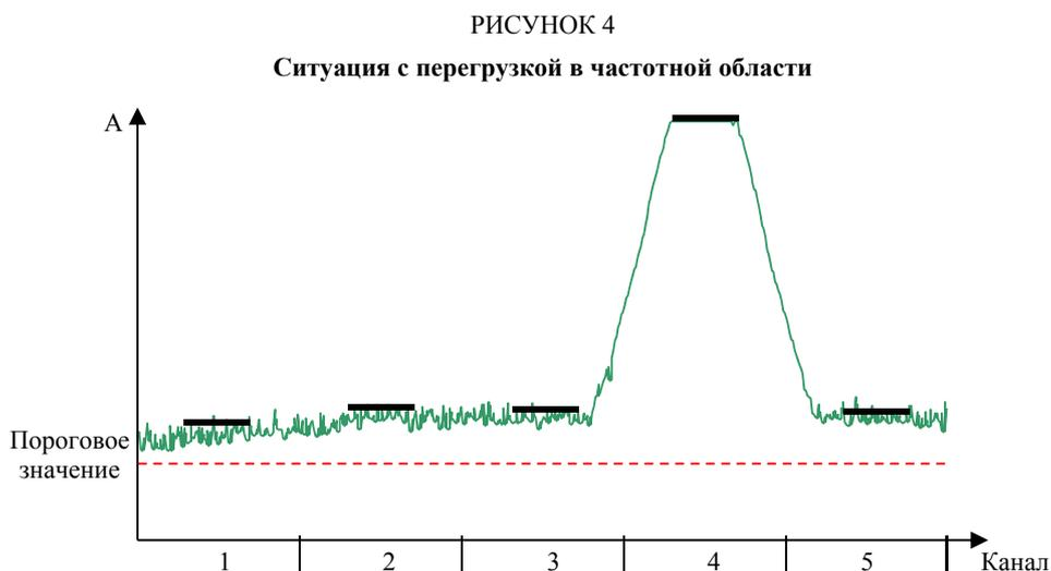
На рисунке 4 показана та же ситуация с занятостью, что и на рисунке 2, с тем отличием, что высокий уровень излучения в канале 4 приводит к перегрузке измерительного оборудования. В результате все пять каналов выглядят занятыми. Данная проблема не может быть решена радикально даже путем увеличения порогового значения, поскольку в этом случае данные о фактической занятости канала 2 пропадут.
