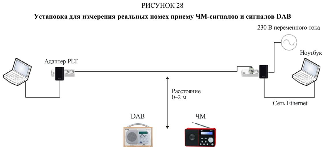
Каждый адаптер Belkin-F5D4076 был подключен к тройной розетке, а кабель питания тройной розетки длиной 3 м был расположен на боковой стене комнаты на высоте стола. ЧМ-радиоприемник (DNT) и DAB-радиоприемник (PURE) были установлены на столе перед кабелем. Во время измерений для целей исследования помех расстояние до кабеля изменялось поэтапно в диапазоне от 0 до 2 м.
