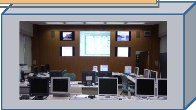
Le centre est équipé de processeurs de traitement, d'enregistreurs de données et de lecteurs servant à la commande des opérations et aux activités de contrôle du système. Il dispose de terminaux de commande qui régissent la réception et la mesure des ondes radioélectriques à la liaison de contrôle.
