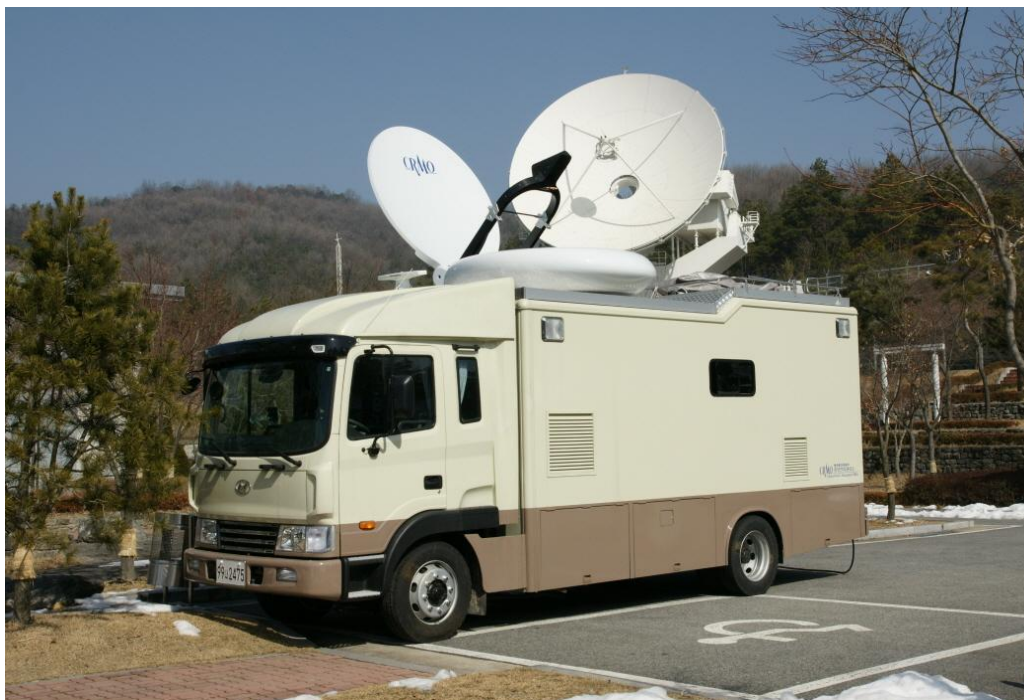
Передвижная система контроля спутниковой радиосвязи
