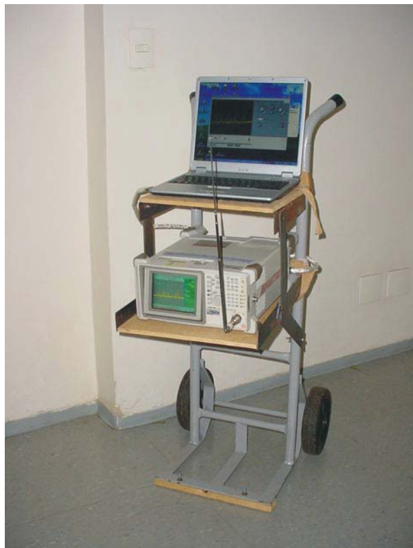
FIGURE 7 Exemple de composition d'assistant de mesure utilisant une interface GPIB
