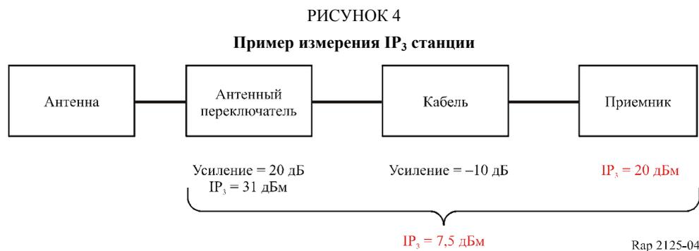
Антенны могут создавать интермодуляционные составляющие, которые следует охарактеризовать. Эти нелинейности создаются активными элементами и/или согласующими трансформаторами. Поэтому в результате измерения будут предоставлены значения  $IP_2$  и  $IP_3$  на выходах антенн (P1).
