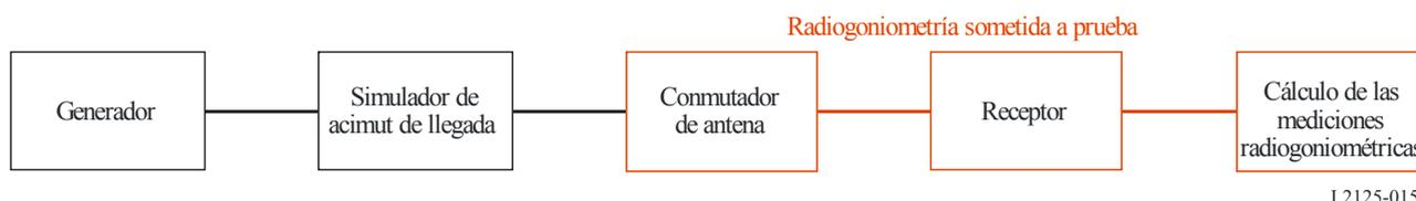
El método de medición es el mismo que en el caso de un EPZA salvo que el acimut teórico viene dado por el simulador de antena.
