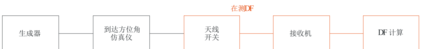
平台测向电台的DF精度测量设置
