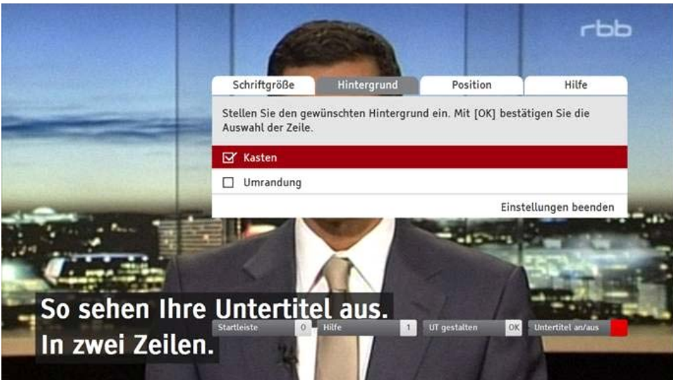
图14.2 通过综合广播宽带传输的字幕测试结果 截屏图片中，菜单是用来选择通过互联网传送的字幕的大小、背景和位置的。 (本例中将字幕放置于电视图像的底部，中号字体和85%透明度的黑色背景)
