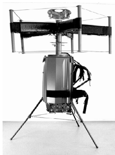
б) Антенна 20-3000 МГц в развернутом состоянии с установленным компактным приемником и пеленгатором
