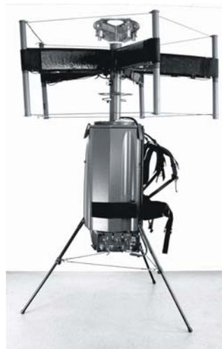
b) Antenne fonctionnant dans la bande 20-3 000 MHz; dans une configuration où un récepteur compact et un système radiogoniométrique sont installés
