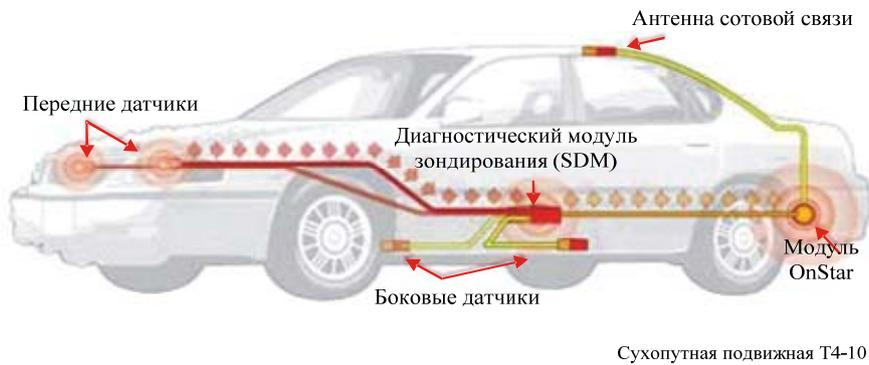
На Рисунке 11 показано, что в случае умеренной или серьезной аварии в передней или боковой части автомобиля данные от затронутых датчиков передаются в SDM. Кроме того, датчик SDM может определить удар сзади достаточной интенсивности. Независимо от того, сработают ли подушки безопасности, SDM передает информацию об аварии модулю OnStar автомобиля, передавая сообщения с сотового телефона.
