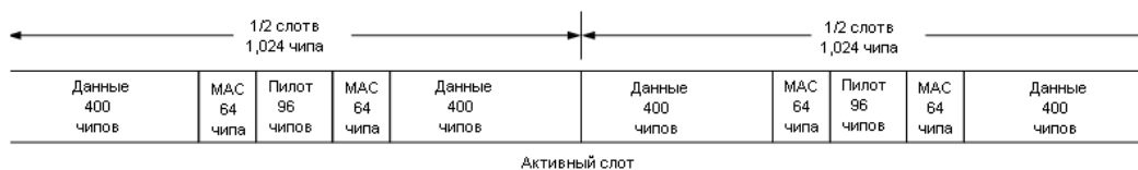
Рисунок 8 – Структура слота нисходящего канала 1xEV-DO Вариант 0
