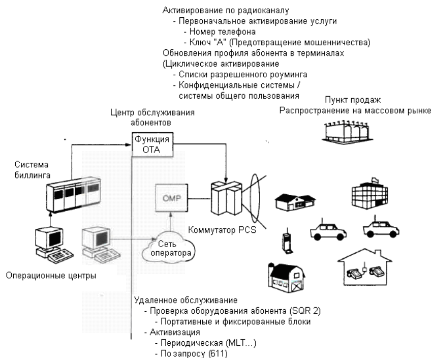
Рисунок 4 – Объединенный центр биллинга и обслуживания абонентов системы WLL на базе CDMA2000
