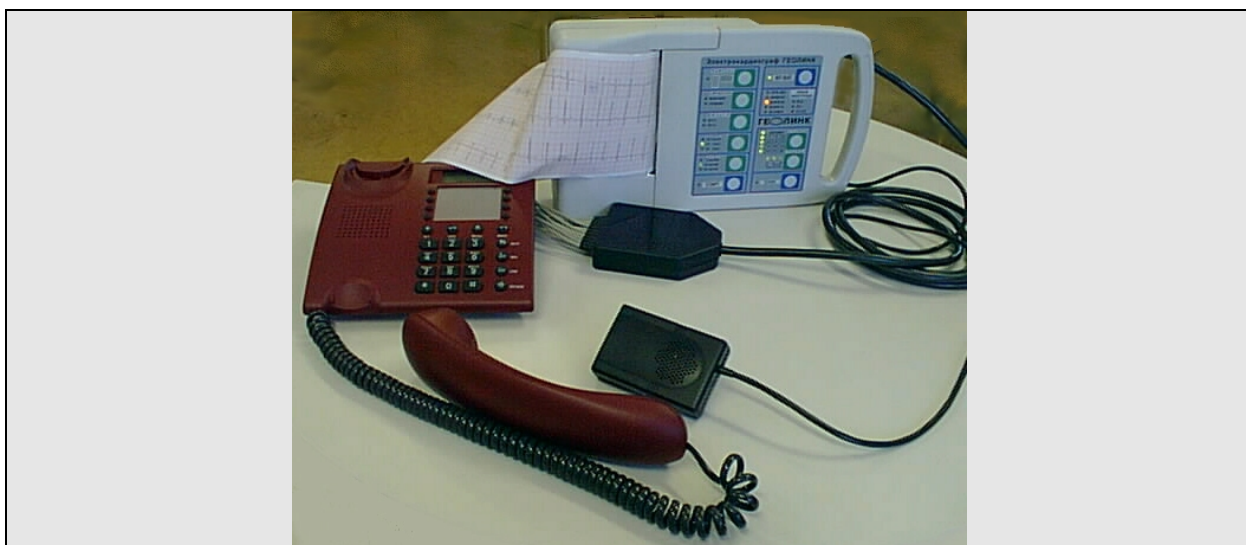
Figure 4 – Matériel nécessaire pour émetteur ECG professionnel en position fonctionnement
