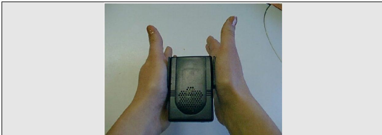
Figure 3 – Emetteur personnel ECG en position enregistrement
