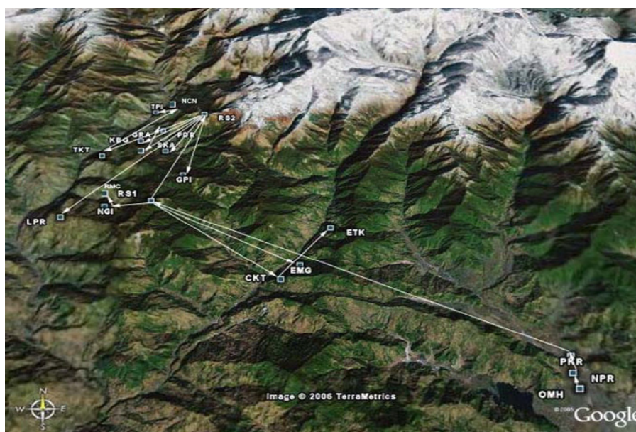
Беспроводная сеть Непала в Гималаях, использующая режим Wi-Fi для линии доставки сигнала и доступа
