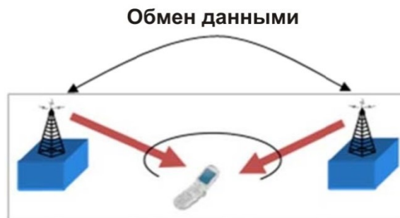
Рисунок 9: Координированный многопунктовый режим работы (CoMP)
