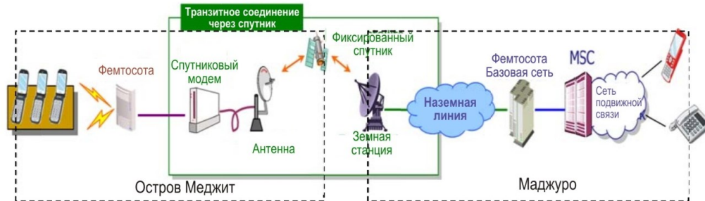
Рисунок 3: Конфигурация сети с использованием фемтосот с транзитными соединениями через спутник
